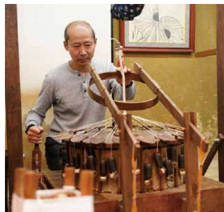
江戸時代に発明された手動式組台「内記台」
